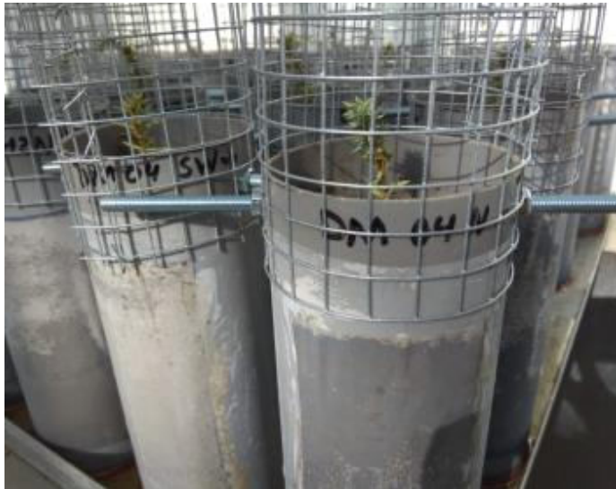
Figuur 22: roterende cilinders. In stukken regenpijp van 22cm hoogte en 8cm diameter zijn ramen gezaagd. Over deze ramen is gaas met een maaswijdte van 38µm geplakt. Door de kleine maaswijdte kunnen wortels niet naar buiten groeien en schimmels wel naar binnen. De rode dop sluit de onderkant af. Het gaas aan de bovenkant beschermt de plant tegen herbivoren. Het ronddraaien van een cilinder om haar as zorgt ervoor dat schimmels die door het gaas groeien worden doorgesneden door het gaas. Hierdoor kun je een behandeling creëren zonder mycorrhizerende schimmels. Zelfs als een schimmel erin slaagt de wortel van de plant te bereiken dan blijft het mycelium (het netwerk van de schimmel) beperkt tot de grootte van de cilinder
